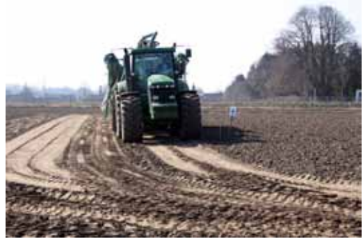
Parcelle bliver pakket hjul ved hjul, så hele parcellen bliver overkørt af gyllevognen. (Foto: Janne Aalborg Nielsen, Videncentret for Landbrug).
